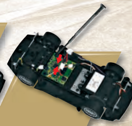
Platine festschrauben und Chassis schließen
