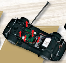
Schrauben lösen, Platine entnehmen
